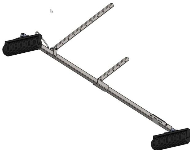
Die Schutzgeländer werden an der Dachkante oder am unteren Dachende befestigt und beinhalten das Sicherheitszubehör (Abschlussleisten, Fußleisten, Netze), um einen vollständigen Schutz zu gewährleisten.
